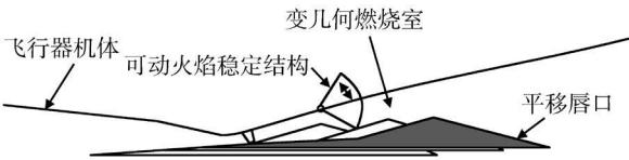
图 2 伸缩唇口式变几何进气道结构示意图 [9]
